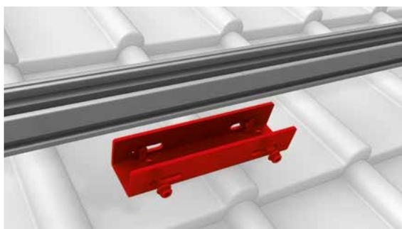
Poser les Rail de montage bout à bout et assembler à l'aide du connecteur de rails et des vis à tête marteau et écrous de blocage. Le joint entre les rails ne doit pas être situé dans la zone du crochet.
