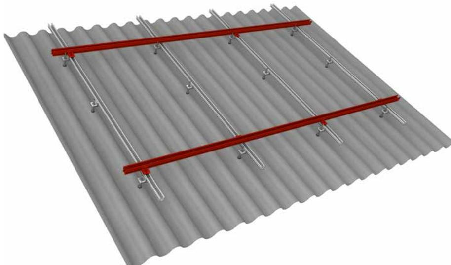
La rangée supérieure de rails (montage en croix) est fixée à l'emplacement souhaité et avec un intervalle adapté à l'aide de l'écrou prisonnier MK2 et le Kit Climber.
