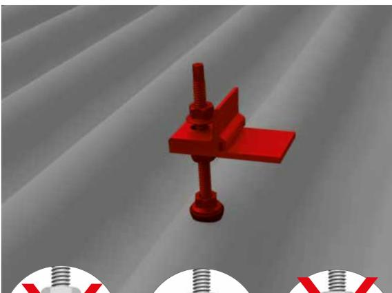
Avant le montage de la fixation de panneaux solaires, veuillez nettoyer la surface et retirer tout copeau de perçage. Vis à double filetage est introduite dans le trou pré-percé à travers et vissée en orientation avec la butée.
