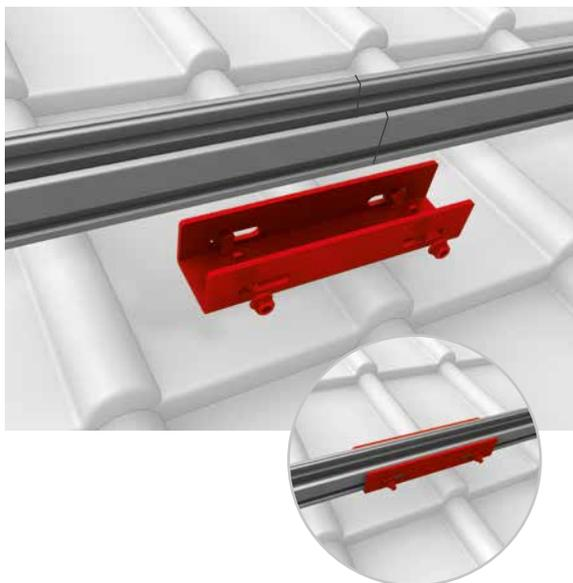
Poser les Rail de montage bout à bout et assembler à l'aide du connecteur de rails et des vis à tête marteau et écrous de blocage. Le joint entre les rails ne doit pas être situé dans la zone du crochet.
