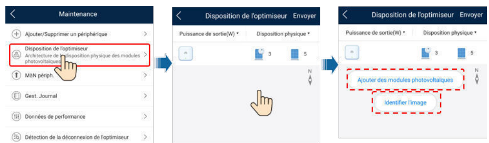
Figure 7-8 Disposition physique des modules PV
